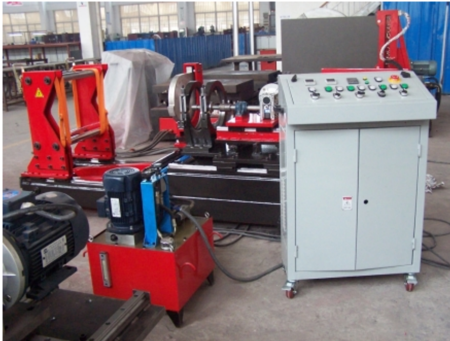
Máquina ATT / Branch, para TEEs en HDPE con arranques directos en 90°
